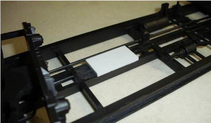
Auf diese Streife werden 2 weitere Streifen (30mm L x 10 mm B x 2 mm D) quer geklebt mit am Ende ein senkrecht stehendes Teil in PS (15 mm L x 8 mm B x 1 mm Dicke).
