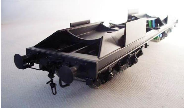
Im Rahmenmitte am Innenseite, Unterseite, macht man, in die dreieckige Versteifungen des Mitten Querträgers (an beide Wagenseiten), eine Bohrung (1mm D) um später eine Splinte (1mm) ein zukleben als Halterung für die Entlüftungsstange.
