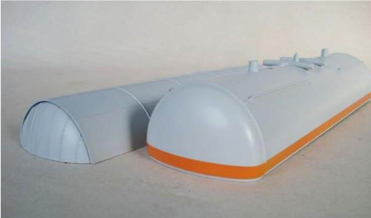
Vorher die Kesselhälfte wiederum zusammengeschaubt werden kann ein Zusatzballast von 200 gram (z.B. Aquarium Steinschotter oder Sand in eine Tute) eingeklebt werden.
