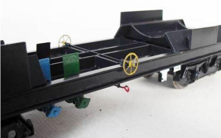
Die Schraubkupplungen und Hochleistungspuffer werden montiert. Auch die alte Bühne wird wieder aufgeklebt und die Treppen beklebt mit Riffelblech.
