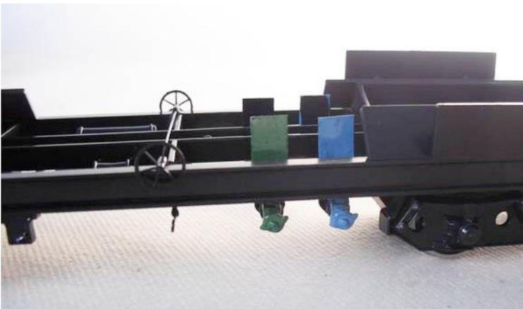
Die Handräder werden gelb (Ral1023 Verkehrsgelb) und die Entlüftungs- Handgriffe werden rot (Ral 3020 Verkehrsrot) lackiert.
