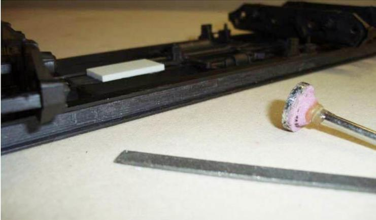
Im Falle man mit Schleifen kein gute Erfolg bekommt, kann man das Längsträgermitte mit eine Kunststoff Leiste bekleben. (PS 5 x 1 mm)
